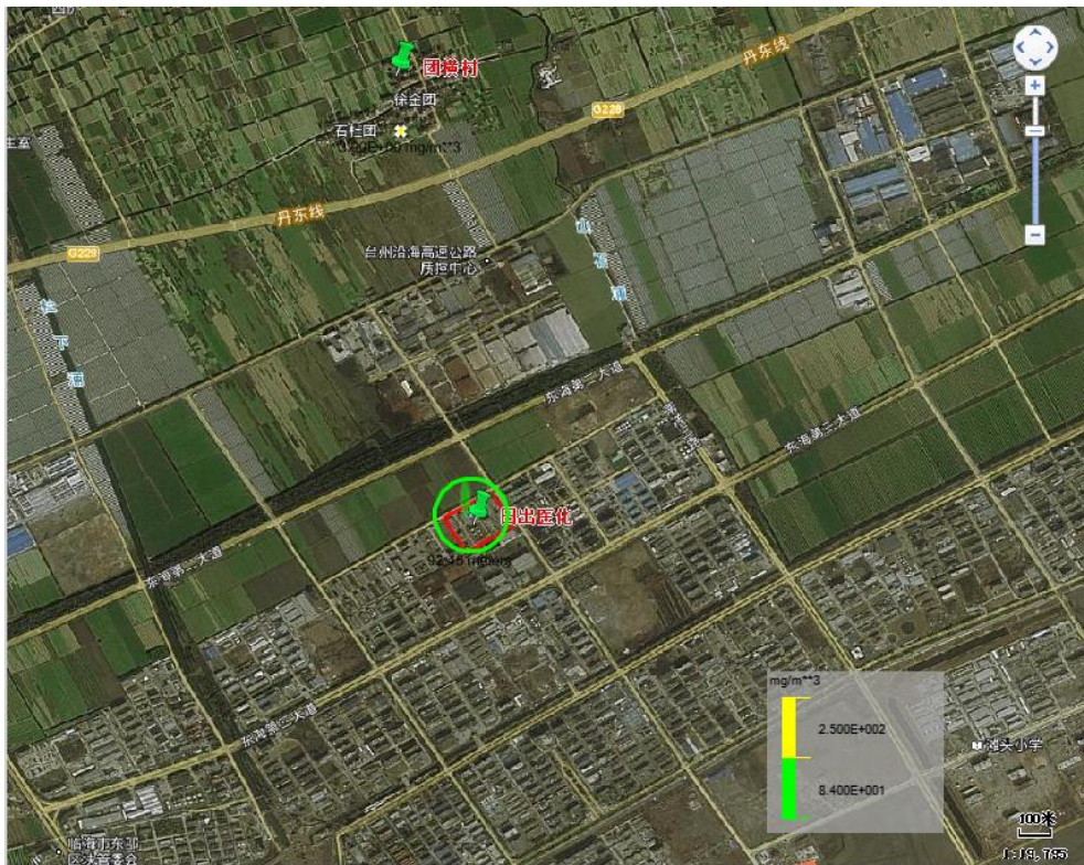
图 1.5-9 乙腈储罐泄漏影响预测图
